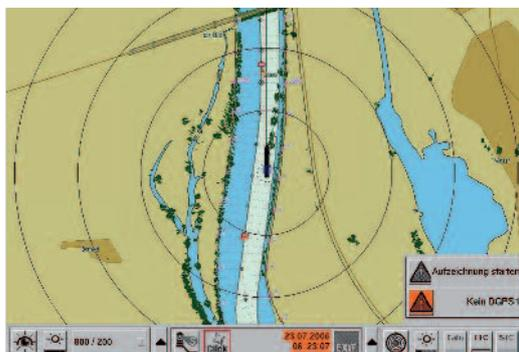
Bei Nacht und Nebel kann sich der Schiffsführer am Radarbild orientieren: Die Radarantenne über dem Steuerhaus sendet Funksignale aus und fängt das zurückgeworfene Echo wieder auf. Daraus setzt das Gerät ein Bild der Umgebung zusammen.
