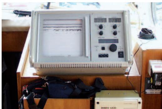
Das Echolot sendet Schallwellen zum Gewässergrund und fängt das Echo wieder auf. Daraus ist die Wassertiefe unter dem Schiff ablesbar.
