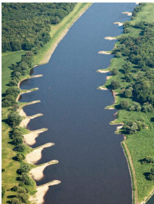
An vielen Flüssen sieht man zahlreiche gepflasterte oder mit Schotter bedeckte Bauwerke senkrecht in den Fluss hineinragen. Diese Bauwerke nennt man Buhnen, die Flächen zwischen den Buhnen heißen Buhnenfelder. Bei Hochwasser sind Buhnen oft überflutet und nicht mehr sichtbar. Buhnen werden schon seit Jahrhunderten in die Flüsse gebaut. Ursprünglich dienten sie der Landgewinnung und dem Schutz des Ufers vor Hochwasser, besonders bei Eisgang.
