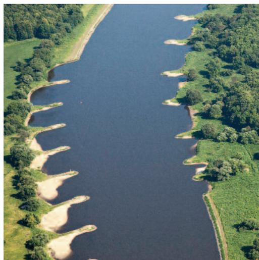
Die Spitze einer Buhne zur Flussmitte hin heißt Buhnenkopf. An einem Buhnenkopf darf man niemals baden gehen, da sich hier oft reißende Strömungen und Wirbel im Fluss bilden!
