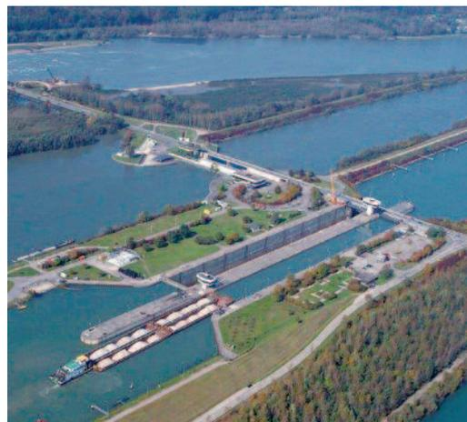
Schleusen sind sozusagen Aufzüge für Schiffe. Sie werden eingesetzt, wenn Schiffe von einem höher gelegenen Wasserabschnitt in einen tiefer gelegenen hineinfahren wollen oder umgekehrt. Das kann man sich vorstellen wie eine Treppe. Und da Schiffe nicht Treppen steigen können, müssen sie mit einem Aufzug von Stufe zu Stufe fahren.
